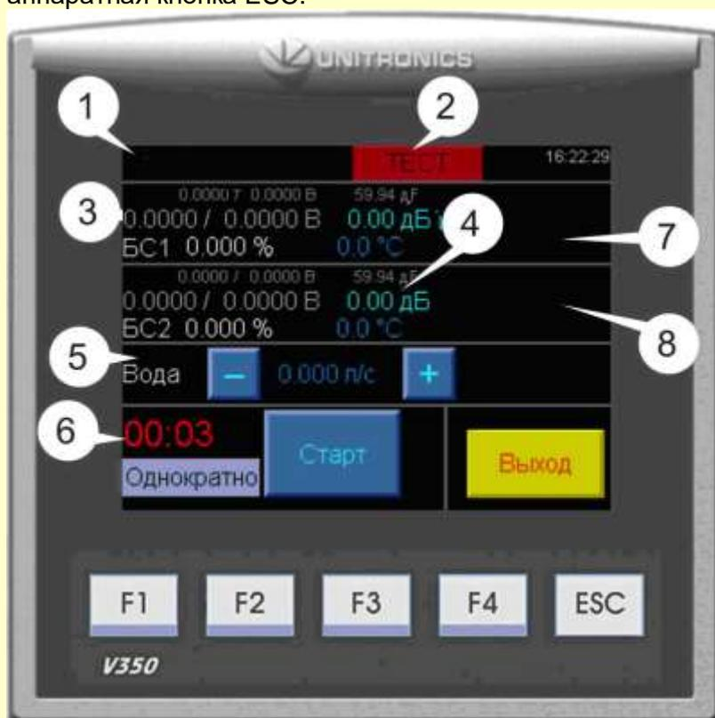
Рис. 5.3.1. Экран ПЛК в режиме «Тест»
