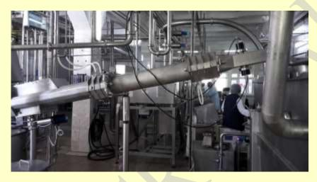
Установка MP113К20M на маслоизготовителе MC9 SIMON FRERES. Диапазон влажности 15-27%, среднеквадратическое отклонение 0,21%.
